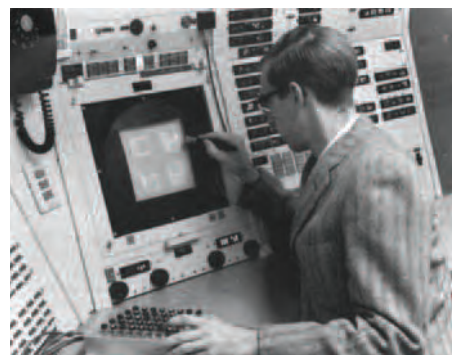
▲ Fig. 6. Ivan Sutherland 1963 sviluppò il sistema in cui l'utente interagiva con il software attraverso una penna ottica su un monitor a raggi catodici.
