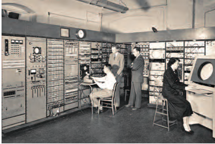
▲ Fig. 3. Il computer Whirlwind , sviluppato presso il Massachusetts Institute of Technology (MIT), pesava 250 tonnellate, alimentato da 12.500 valvole termoioniche e riempiva una edificio a due piani.
