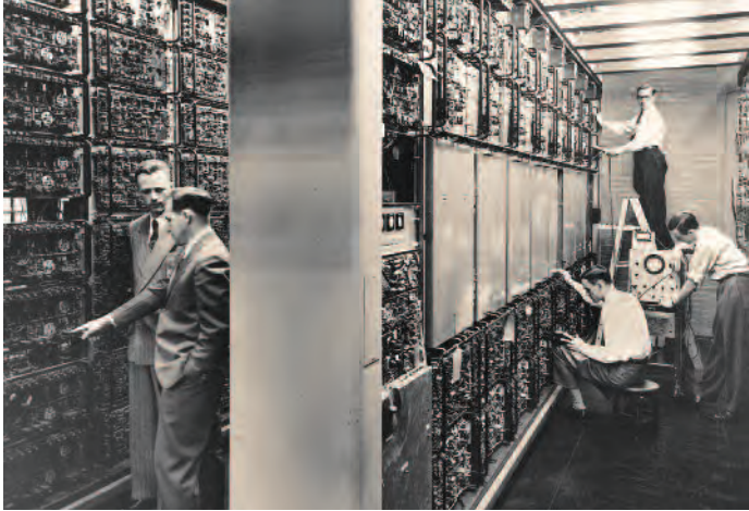
▲ Fig. 3. Il computer Whirlwind , sviluppato presso il Massachusetts Institute of Technology (MIT), pesava 250 tonnellate, alimentato da 12.500 valvole termoioniche e riempiva una edificio a due piani.
